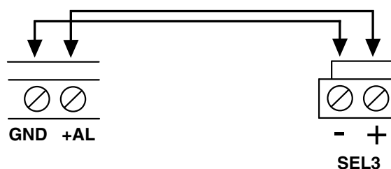
□ Fig. 4.1. Collegamento del morsetto di RIF della centrale al morsetto di comando della sirena autoalimentata SEL26F.
