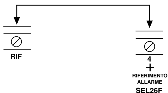
□ Fig. 4.1. Collegamento del morsetto di RIF della centrale al morsetto di comando della sirena autoalimentata SEL26F.
